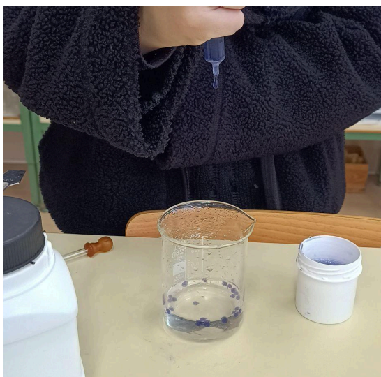
Imagen 1. Preparación de las esferas de alginato con el extracto de col lombarda.
