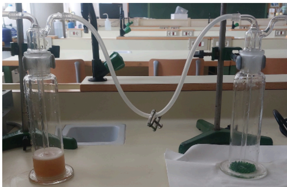
Imagen 4. Diseño experimental del sistema de captación de dióxido de carbono en aire.
