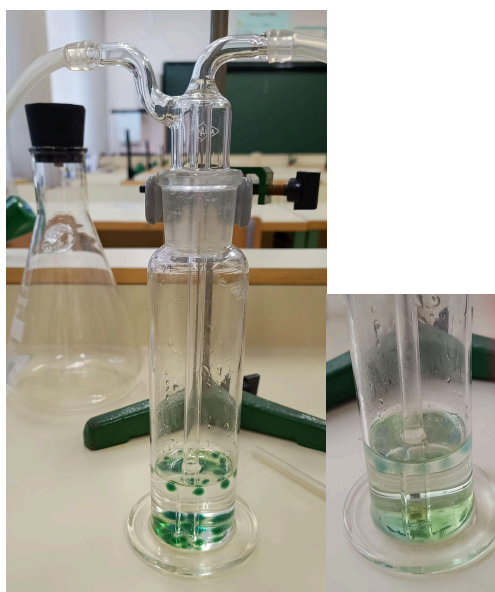
Imagen 6. Observación del cambio de color de las esferas de alginato cuando se burbujea dióxido de carbono sobre agua.
